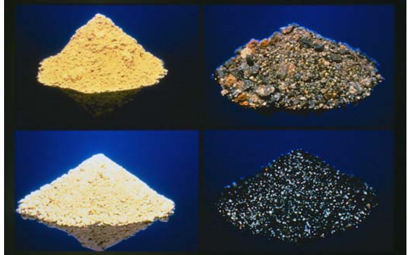
Top left to bottom right: 1) fly ash 2) bottom ash 3) FGD material 4) boiler slag
